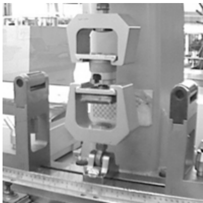
Figure 7. Superficial tensile test
